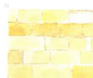
3) appareillage en pierre de taille régulière.
