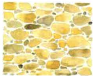
3) appareillage de gros et petits moellons non équarris et non assisés.
