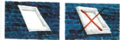
Pour une bonne intégration dans la toiture, les fenêtres de toit doivent se trouver au nu de l'ardoise.
