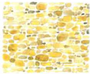
1) appareillage de moellons équarris sur une seule face en parement et non assisés.
