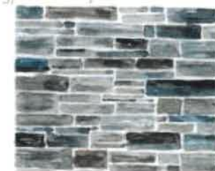
4) appareillage en pierre de schiste assisée.
