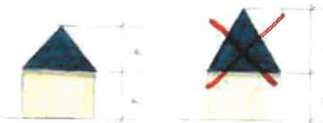
Les proportions murs-toit devront être respectées, afin de conserver une silhouette de la maison équilibrée.
