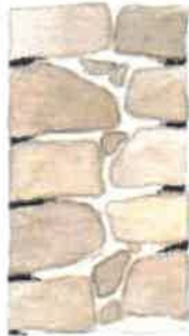
Joints fins affleurant le parement
