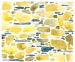
2) appareillage de moellons de granite et pierres de schiste non assisés.
